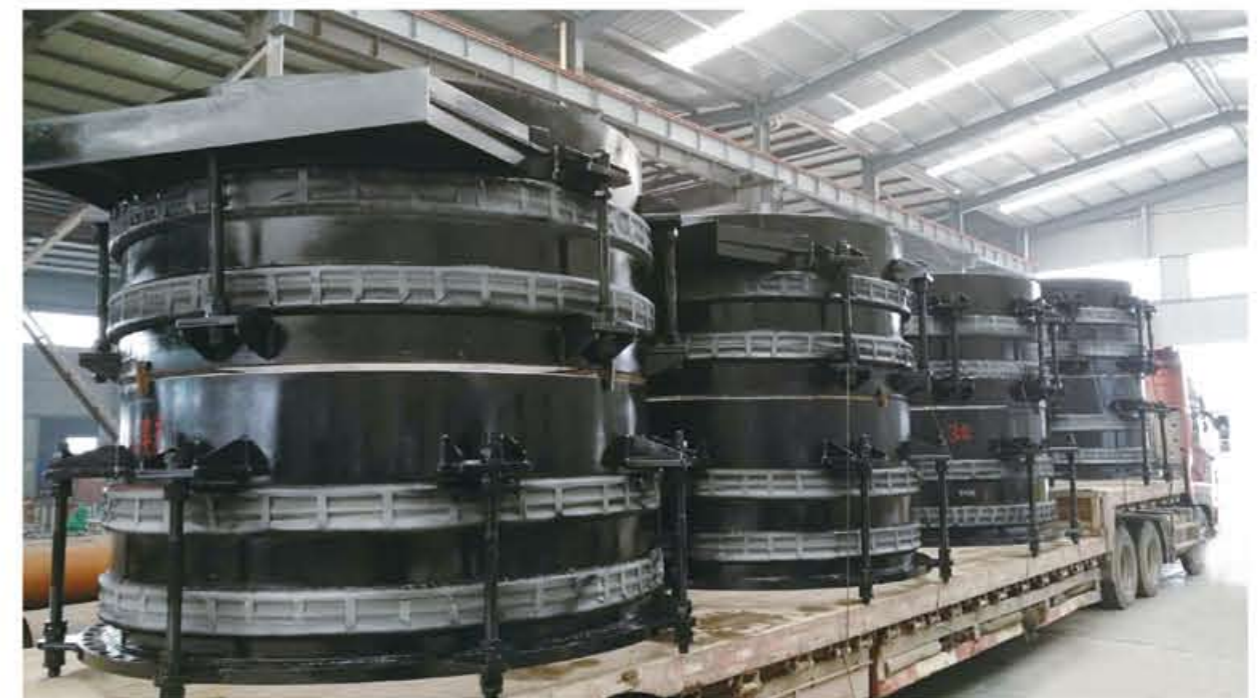
循环水管道膨胀节
